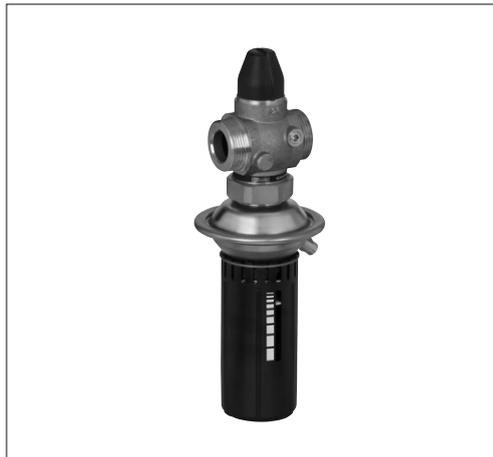
Der Regler besteht aus einem Regelventil mit einstellbarer Volumenstrombegrenzung, einem Antrieb mit Stellmembrane und einem Handgriff für die Einstellung des Differenzdrucksollwerts (ohne Handgriff bei der Ausführung mit festem Sollwert).
