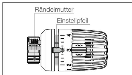
Der IMI Heimeier Thermostat-Kopf VK, Thermostat-Kopf D und Thermostat-Kopf DX mit Klemmanschluss ist für die Montage an Ventilheizkörpern mit Thermostat-Oberteil für Klemmverbindung vorgesehen.
