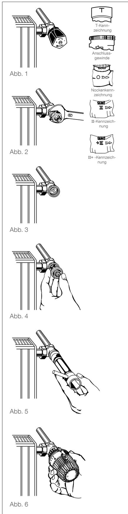
Alle IMI Heimeier-Mikrotherm-Reguliertventile mit „T“-Kennzeichnung und mit Anschlussgewinde für den Thermostat-Kopf am Gehäuse (Abb. 1) können durch Austausch des Oberteils gegen ein Umbau-Oberteil in ein Thermostat-Ventil umgerüstet werden.
