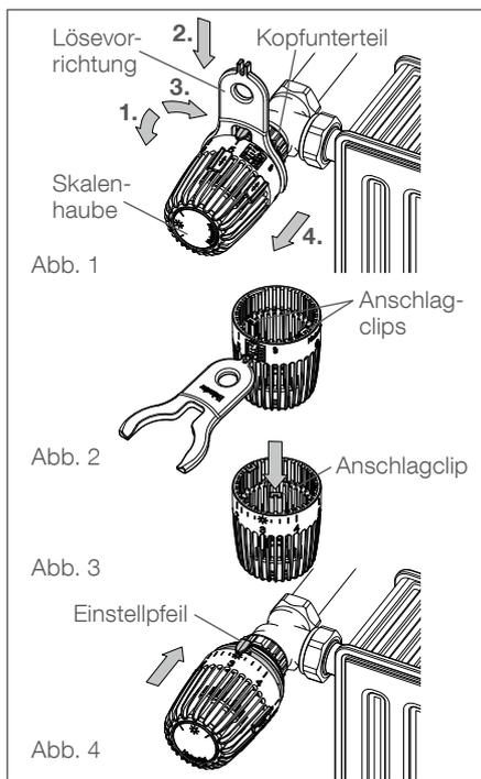
Der Thermostat-Kopf wird werkseitig mit zwei Anschlagclips geliefert. Diese sind innerhalb der Skalenhaube zunächst rechts neben Merzkahl 5 (MAX) und links neben Frostschutzstellung \* (MIN) montiert.
