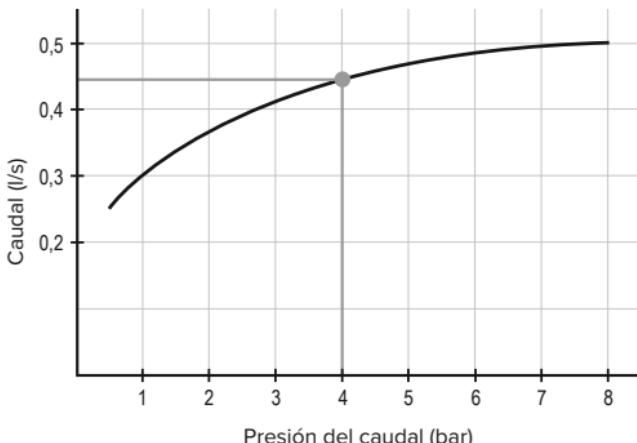
Ejemplo: Presión del caudal 4 bar  $\Rightarrow$  Caudal 0,44 l/s  $\Rightarrow$  con 5 s de tiempo de descarga  $\hat{=}$  2,2 l de volumen de descarga
