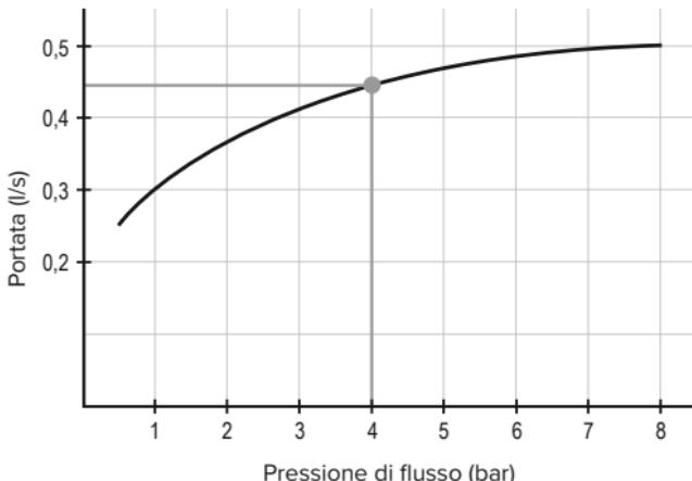
Esempio: Pressione di flusso 4 bar  $\Rightarrow$  portata 0,44 l/s  $\Rightarrow$  con tempo di risciacquo 5 s  $\triangleq$  volume di scarico 2,2 l
