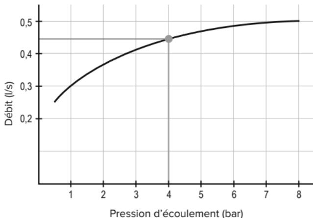
Exemple : Pression d'écoulement 4 bar  $\Rightarrow$  Débit 0,44 l/s  $\Rightarrow$  avec un temps de chasse de 5 s  $\triangleq$  Volume de chasse de 2,2 l
