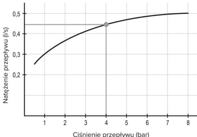
Przykład: Ciśnienie przepływu 4 bar  $\Rightarrow$  Natężenie przepływu 0,44 l/s  $\Rightarrow$  przy czasie spłukiwania 5 s ilość spłukiwanej wody  $\triangleq 2,2$  l
