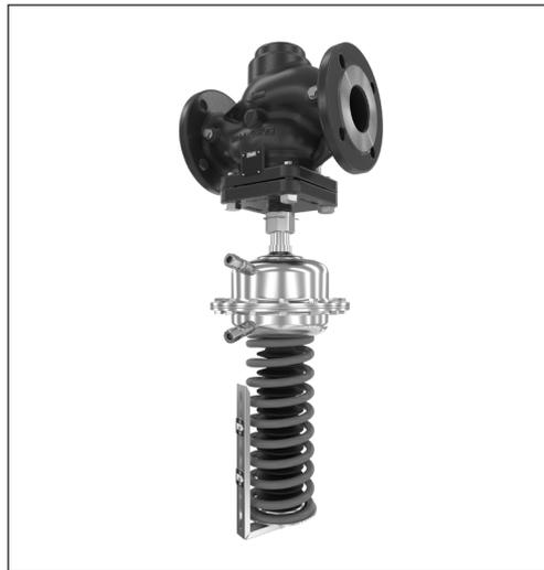
Der Regler ist ein selbsttätiger Druckminderer, der in erster Linie für den Einsatz in Fernwärme- bzw. Fernkältesystemen vorgesehen ist. Der Regler ist drucklos geöffnet und schließt bei steigendem Druck.
