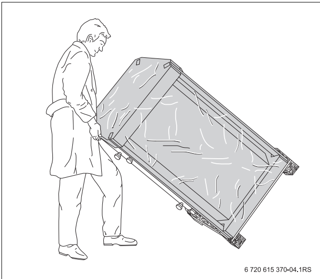
Fig. 4 Mise en place du ballon d'eau chaude sanitaire
