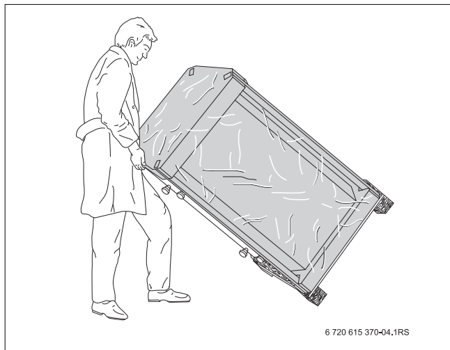
Fig. 4 Colocar el acumulador de agua caliente
