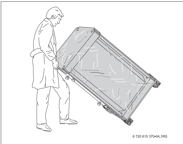
Sl.4 Postavljanje spremnika tople vode
