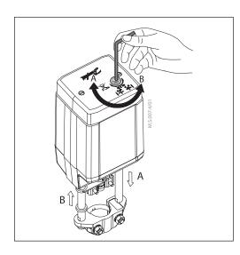
Die Handverstellung erfolgt durch Verstellen mit dem 4-mm-Innensechskantschlüssels (nicht im Lieferumfang enthalten) auf die gewünschte Position. Drehrichtungssymbol beachten.
